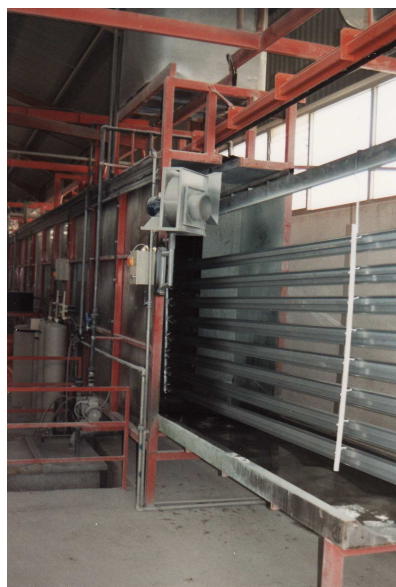
Kombispritzanlage für Stahl mit Eisenphosphatierung und für Aluminium mit Grünchromatierung.
